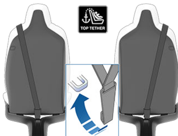
Cinghia di stabilizzazione singola - Sedili monoposto della seconda fila
