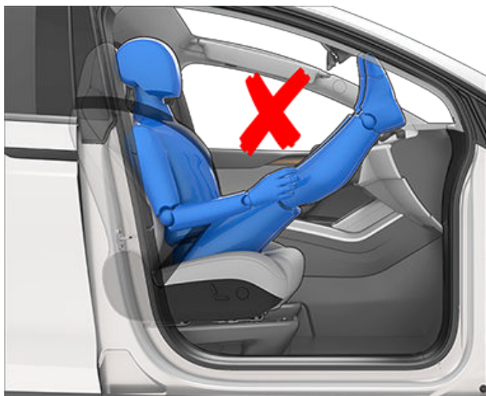
Posizione di seduta non corretta - il passeggero non deve scivolare in avanti sul sedile:
