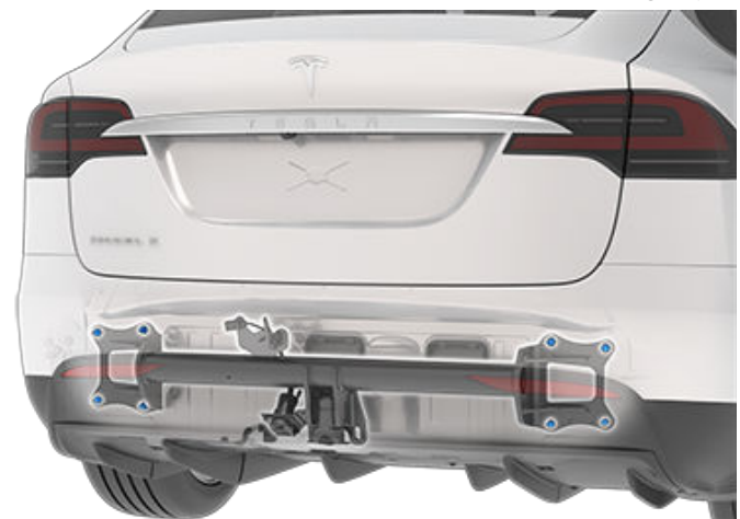
مجموعة حلقة المقطورة متصلة بهيكل السيارة بواسطة 8 صواميل.
