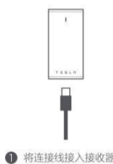
① 将连接线接入接收器
