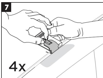
将卡子工具保持不动，然后在箭头位置插入推拉式卡子（11）。
