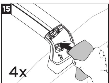
安装护盖。从底部边缘开始，将顶部接入到位。
