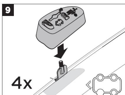
将前驾驶侧垫片（5）放置在前驾驶侧的推拉式卡子上。使用图示来协助识别以及将正确的垫片（5-8）安装到正确的位置。
