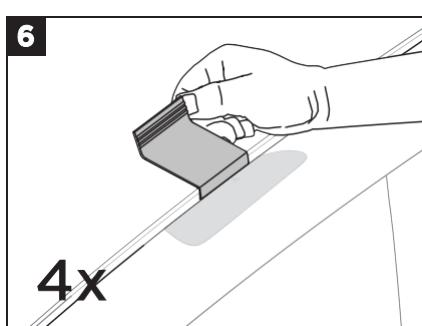
使用卡子工具（1），在箭头位置小心缩回橡胶垫片。
