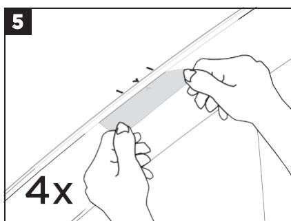
将玻璃上的箭头对齐耐磨胶带（12）上的箭头，然后将（12）耐磨胶带贴到车辆的前驾驶侧，同时将胶带的边缘对准装饰线的边缘。
