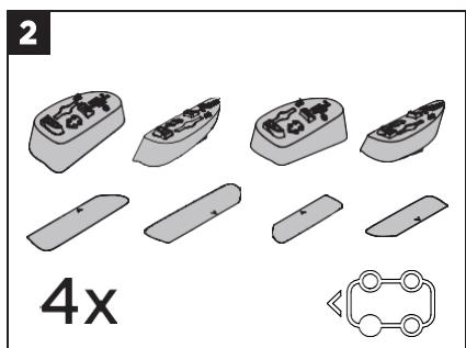
使用垫片（5-8）上的图示协助识别在车辆上的适当位置，然后将耐磨胶带（12-15）对齐垫片（5-8）。
