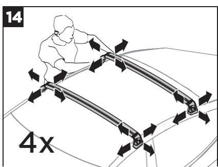
用力向各个方向拉动，测试前、后横梁是否安装牢固。
