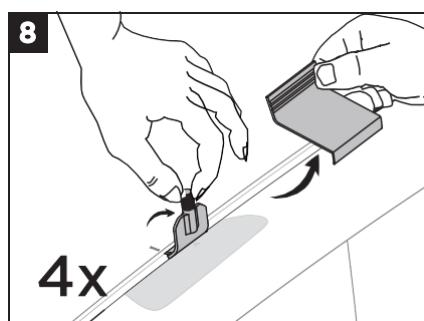
取下卡子工具（1），并确定推拉式卡子（11）嵌入玻璃下方的金属承受端。上拉并摆动以确定正确嵌入。确定钩子的中央对齐箭头。
