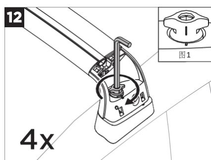
使用六角扳手（2）拧紧螺帽，直到基座牢牢贴附车辆为止。建议拧紧至 2.5-3.5Nm。若要确认基座是否正确完成安装，请向所有方向拉动以确定没有任何移动。为了锁定系统，基座上的标记必须对齐蝶形螺帽上的标记（请参阅图1）。
