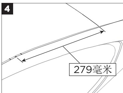
若要定位后方箭头，请从玻璃顶部后缘量起279毫米。
