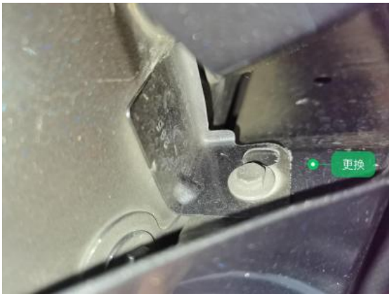
左前翼子板:更换
