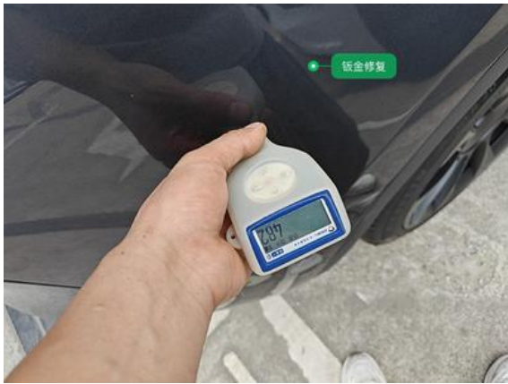
右后翼子板:钣金修复
