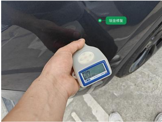
右后翼子板:钣金修复
