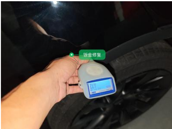
右后翼子板:钣金修复
