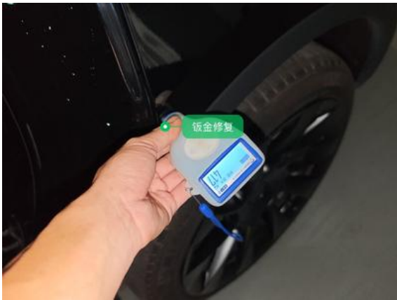
左后翼子板:钣金修复
