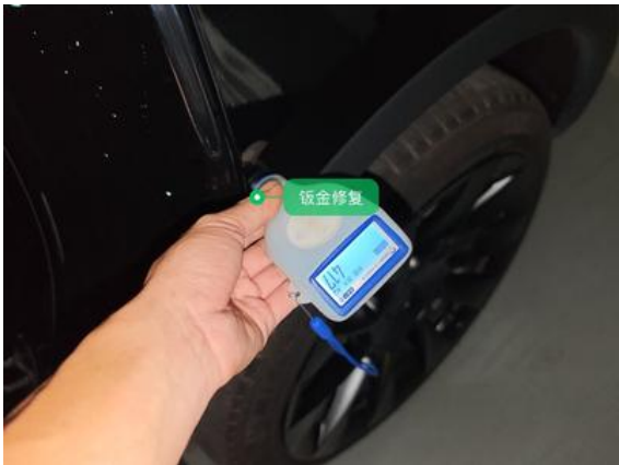
左后翼子板:钣金修复
