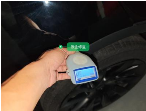
右后翼子板:钣金修复
