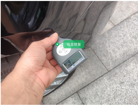
左后翼子板:钣金修复
