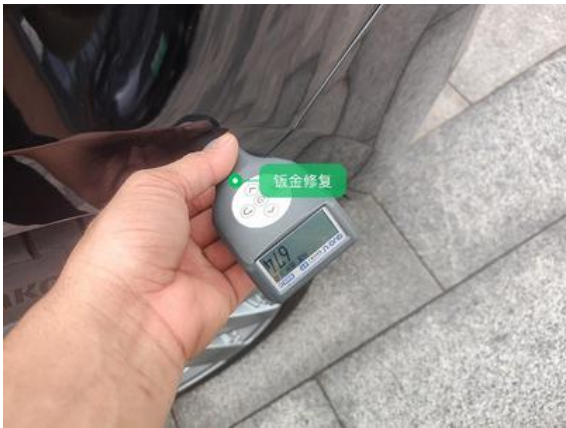
左后翼子板:钣金修复
