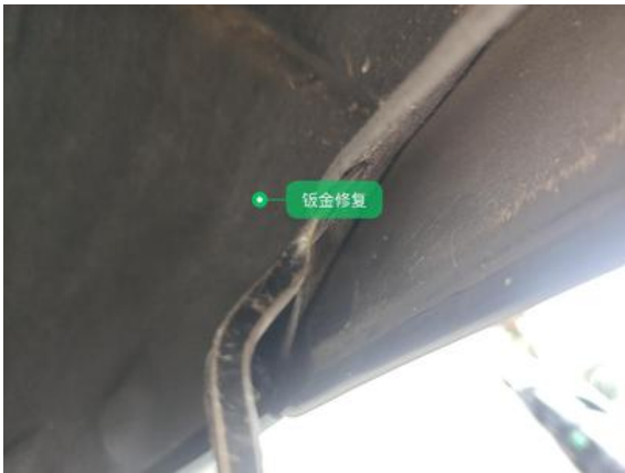
左后翼子板:钣金修复
