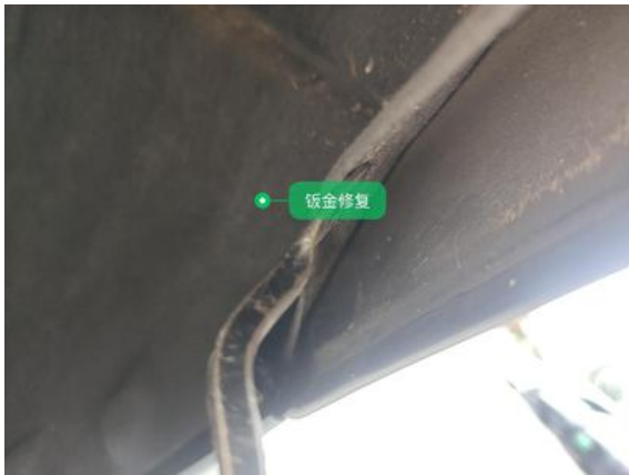
左后翼子板:钣金修复
