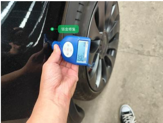
右后翼子板:钣金修复
