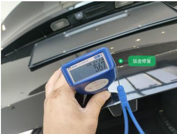
后备箱盖:钣金修复
