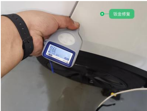
左后翼子板:钣金修复
