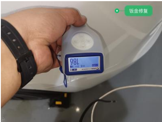
左后翼子板:钣金修复
