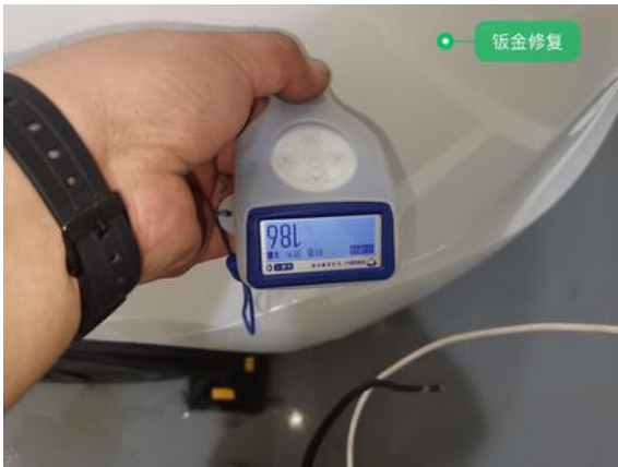
左后翼子板:钣金修复
