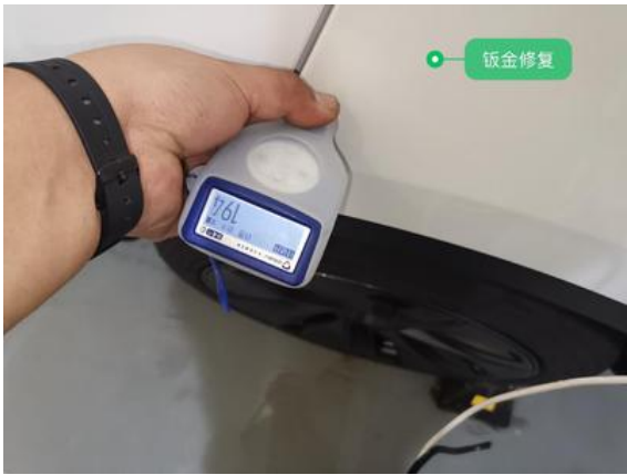
左后翼子板:钣金修复
