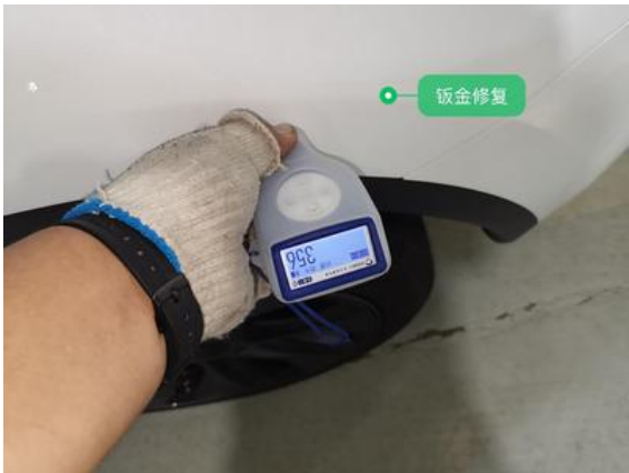
左后翼子板:钣金修复
