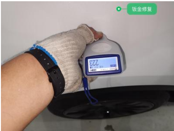
右后翼子板:钣金修复
