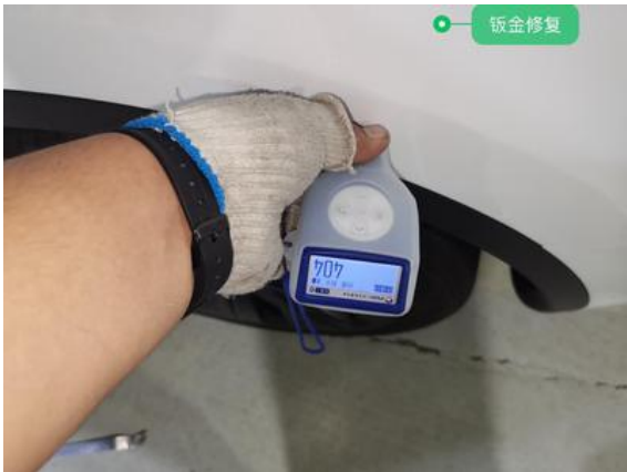
左后翼子板:钣金修复
