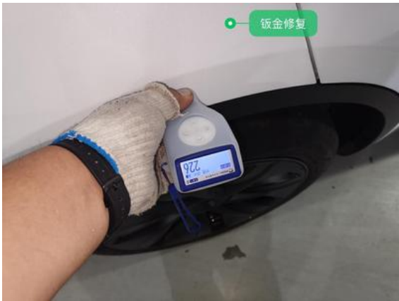
右后翼子板:钣金修复
