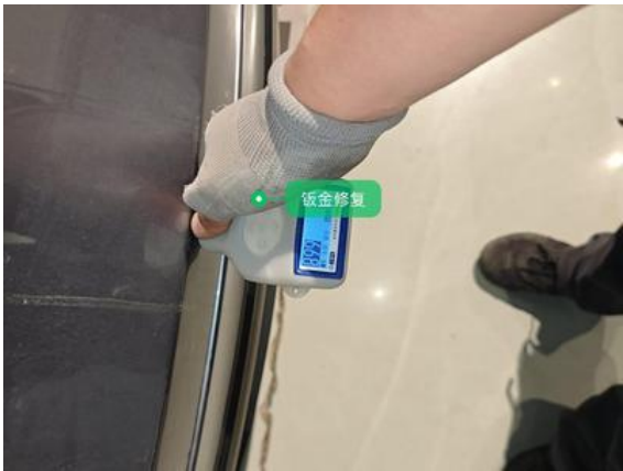
后备箱盖:钣金修复
