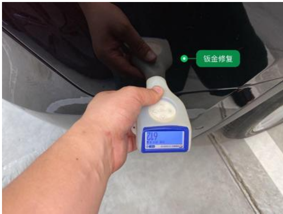
右后翼子板:钣金修复
