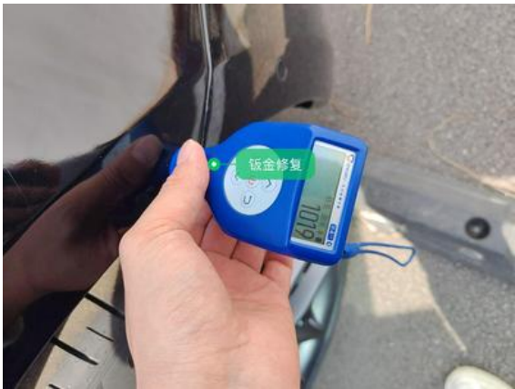
左后翼子板:钣金修复
