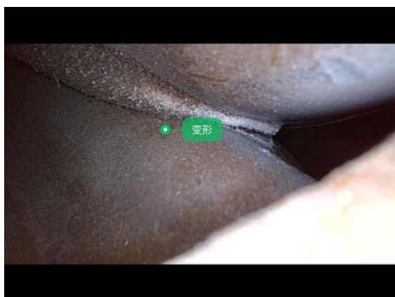
左后翼子板内骨架:变形
