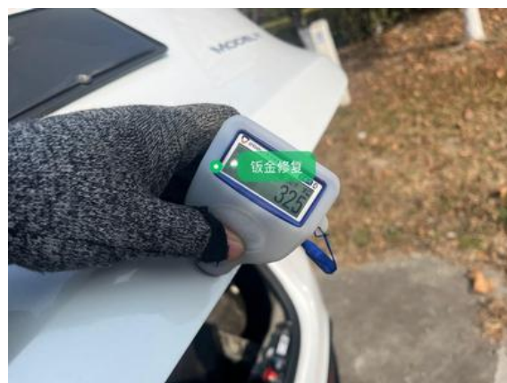
后备箱盖:钣金修复
