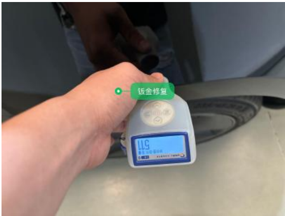
左后翼子板:钣金修复
