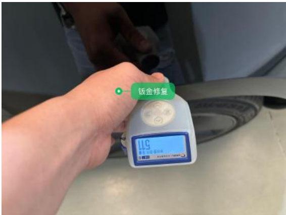
左后翼子板:钣金修复
