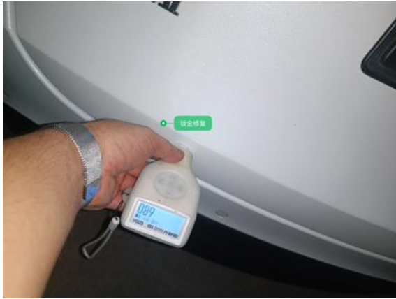
后备箱盖:钣金修复
