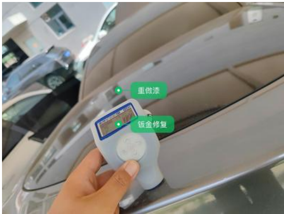
后备箱盖:钣金修复
