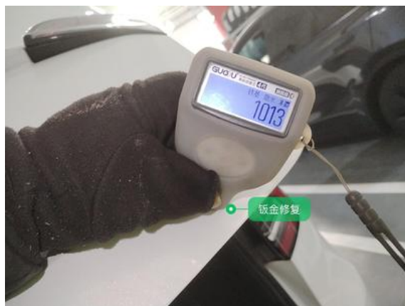
后备箱盖:钣金修复
