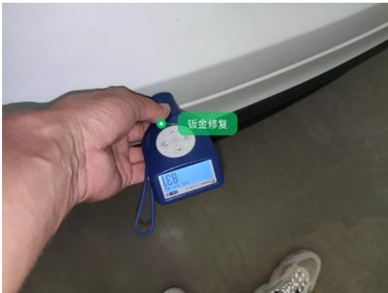
后备箱盖:钣金修复
