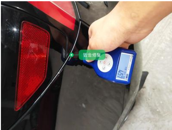
左后翼子板:钣金修复
