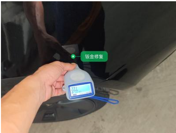
左后翼子板:钣金修复
