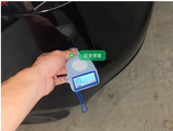
左后翼子板:钣金修复
