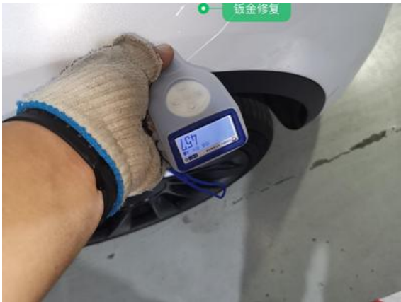
右前翼子板:钣金修复
